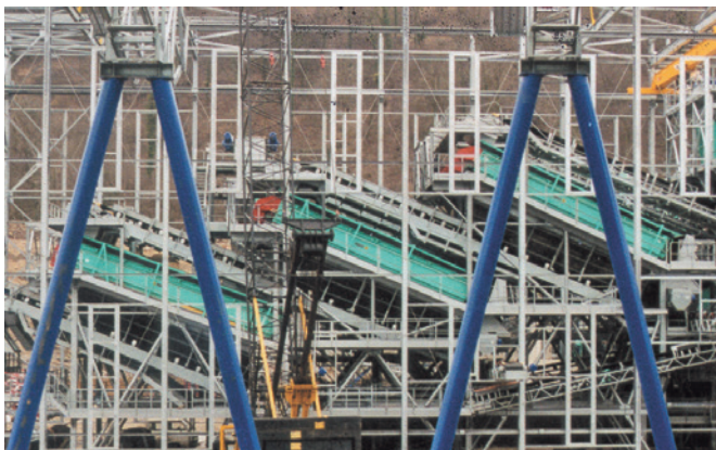
■高炉スラグ設備 納入機種：LF-2.5-8.82/28ED 【能力】20～300t/h 【分離径】2～20mm 【水分】20%以上
