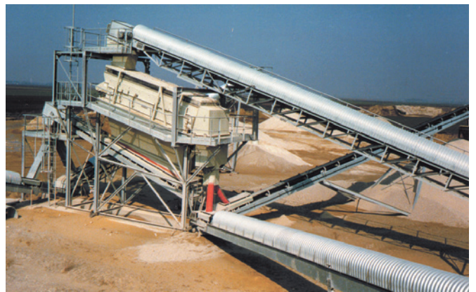
■碎石設備 納入機種：LF-2.0-6.30/20DD 【能力】20～300t/h 【分離径】2～15mm 【水分】10%以上
