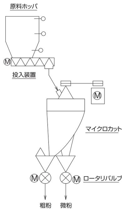
マイクロカット(V形)フロー図(例)
